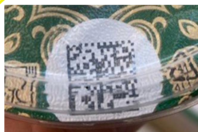
Отсутствие ровного рельефа
