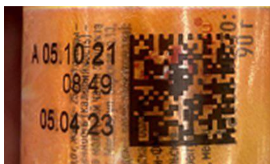
Печать кода маркировки на бликующей/светоотражающей поверхности
