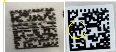
Смазывание кода маркировки или его отдельных элементов
